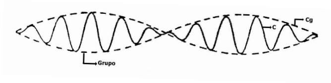
Figura A.2: Formação de grupo como o resultado da superposição de duas ondas.
